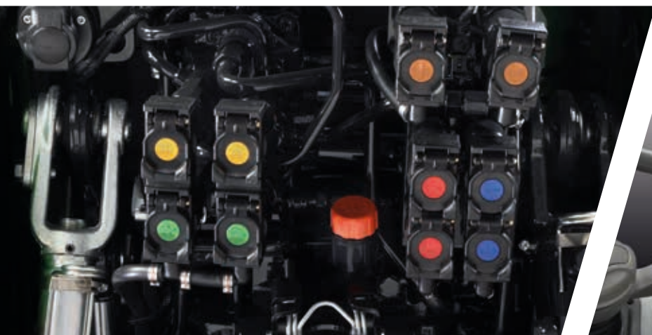
> Hasta 10 vías hidráulicas traseras.
