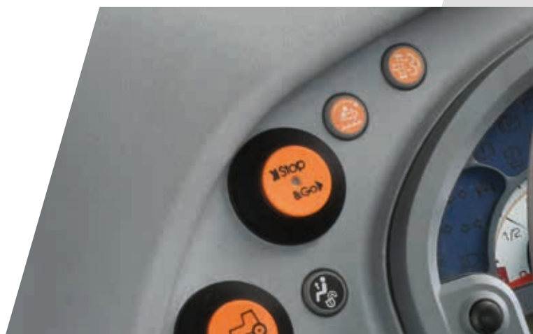
> La función Stop&Go se activa fácilmente mediante un pulsador.
