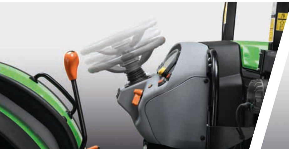
> Columna de dirección regulable en altura.
