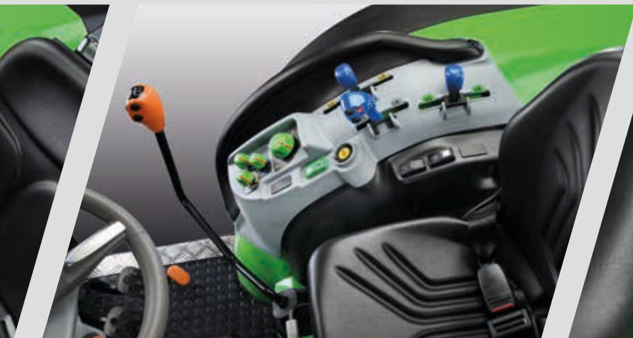
> Controles mecánicos de precisión del elevador trasero y de los distribuidores.
