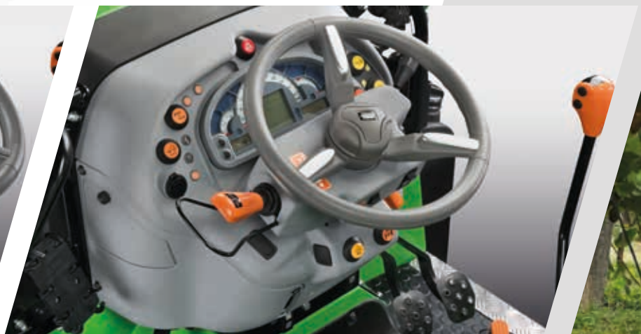
> Inversor electrohidráulico con SenseClutch con 5 niveles de ajuste.
