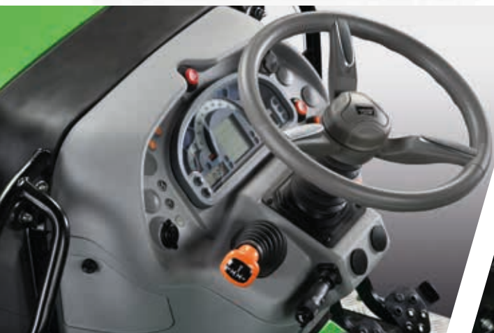
> Inversor mecánico con palanca ergonómica en la columna de dirección.
