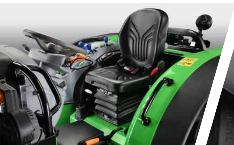
> Asiento del conductor con suspensión neumática para un mayor confort.
