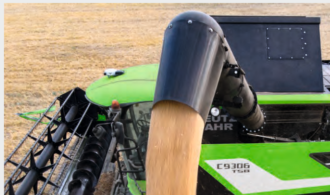
↑ Luz y cámara integradas en el tubo de descarga para controlar las operaciones de descarga.
