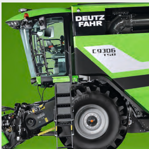
↑ Fácil acceso a la cabina gracias a la nueva escalera con sistema de plegado y desplegado automático.
