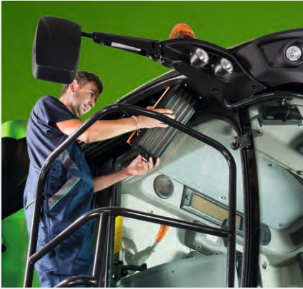
↑ Desmontaje sin herramientas de los filtros de aire de la cabina.
