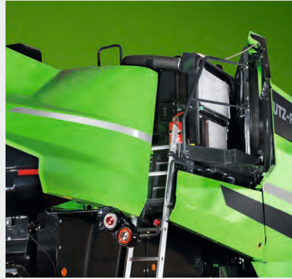
↑ Acceso total a los radiadores: amplia apertura y plataforma específica.
