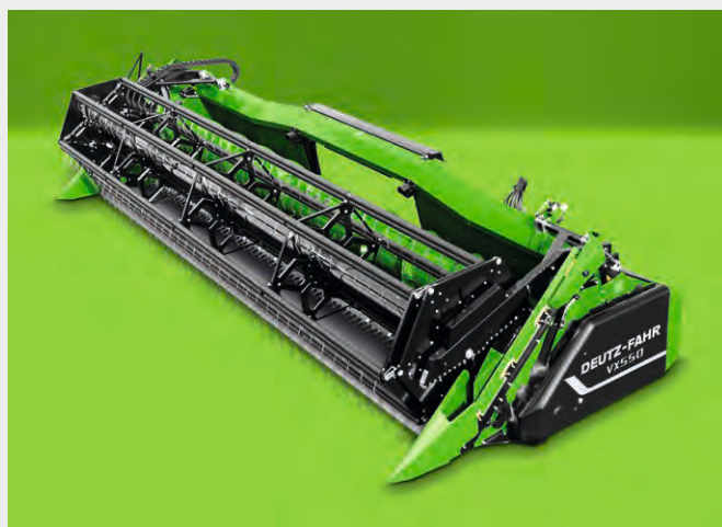
La gama de barras de corte VARICROP incluyen 3 tamaños 5,5, 6,5, y 7,5 m.
