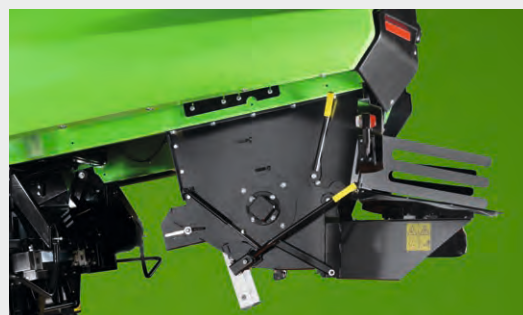
↑ Gran canal de descarga de la paja para maximizar el flujo de producto con paja larga.
