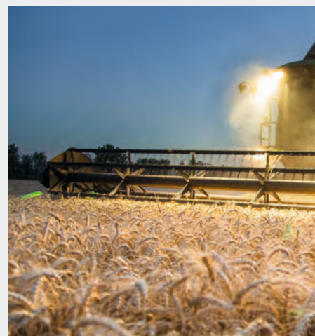
↑ Hasta 10 faros de trabajo en la cabina, las luces traseras recolección nocturna.
