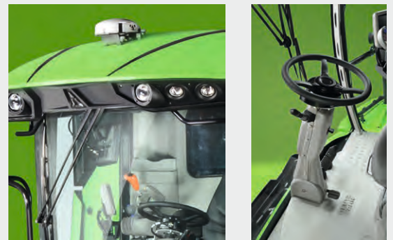
Fácil instalación de los sistemas de agricultura de precisión, integración total de la dirección eléctrica, la antena GPS, los sensores de rendimiento y la centralita electrónica Isobus.
