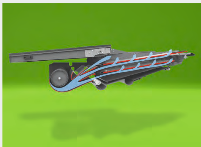
↑ La potente ventilación de la turbina alcanza toda la zona de limpieza y la superficie de separación.
