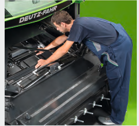
↑ Fácil acceso para ajustar y comprobar las cadenas del canal alimentador.
