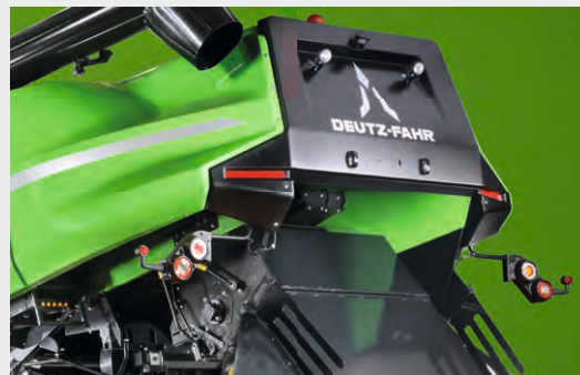
↑ Gran canal de descarga de la paja para maximizar el flujo de producto con paja larga.
