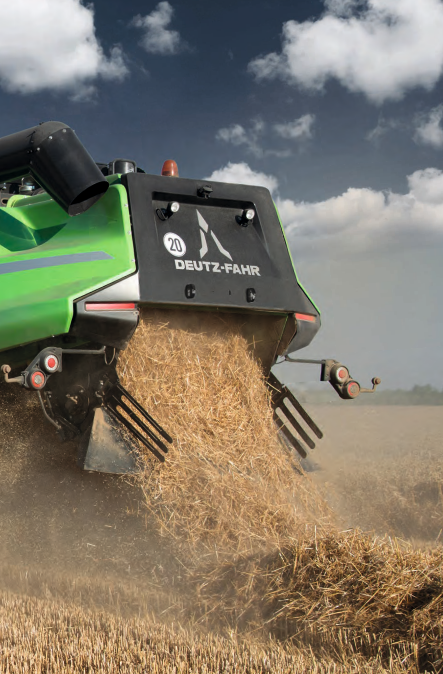
↑ Gran canal de descarga de la paja para maximizar el flujo de producto con paja larga.
