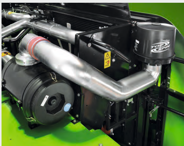
↑ Prelimpieza del filtro de aire del motor con sistema de autolimpieza automática.
