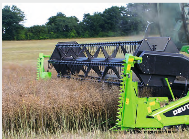
Para la cosecha de la colza, existe un kit específicamente diseñado, que se puede aplicar a todas las barras de corte estándar de DEUTZ-FAHR de hasta 7,2 m.
