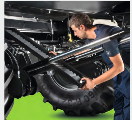
↑ Los segmentos de la bandeja de preparación se extraen fácilmente del atrapapiedras.
