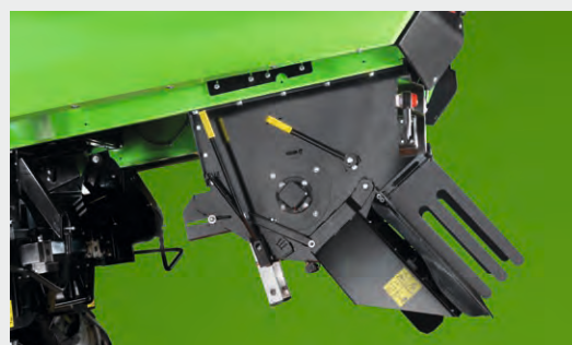
↑ Picador de paja con esparcidor regulable en 3 posiciones. El esparcidor se convierte en un canal para la paja larga cuando no se está utilizando.
