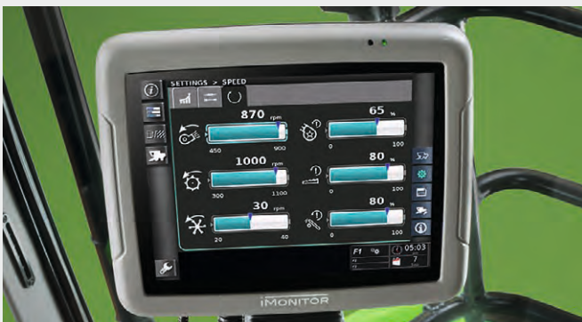
↑ Todos los parámetros y las funciones de la cosechadora se gestionan directamente en el iMonitor.
