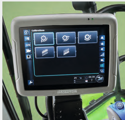
↑ Ejecución y supervisión de la calibración de todos los sistemas principales directamente desde el iMonitor.
