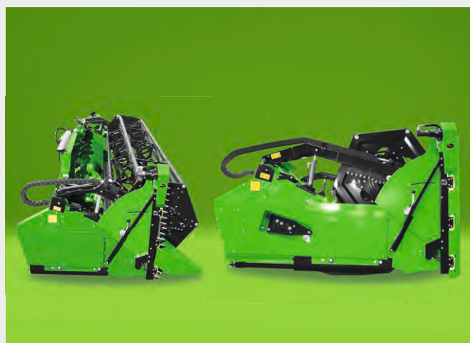
La cama inferior se puede ampliar hasta 700 mm con accionamiento hidráulico. Las cuchillas laterales verticales plegables se accionan hidráulicamente y reducen la operación de conversión de la barra de corte para la cosecha de la colza.
