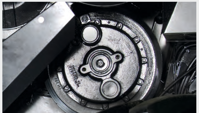
Reductor de velocidad opcional del cilindro de trilla para ajustar las revoluciones del cilindro de trilla de 1.250 a 625 como velocidad máxima y de 420 a 210 rpm como velocidad mínima. Este kit está recomendado para la cosecha del maíz.
